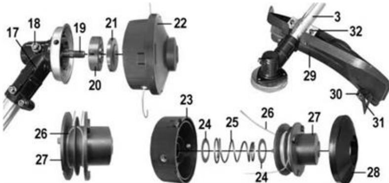
**Рис. 2 Порядок установки на триммер бобины с леской\***
