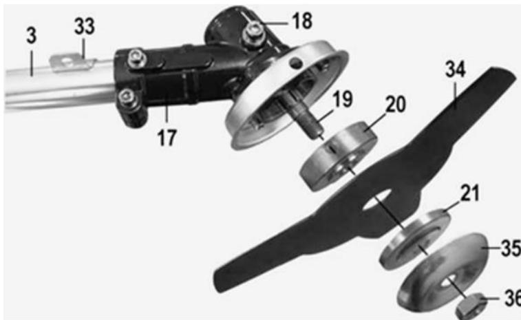
**Рис. 3 Порядок установки на триммер ножа (диска)**
